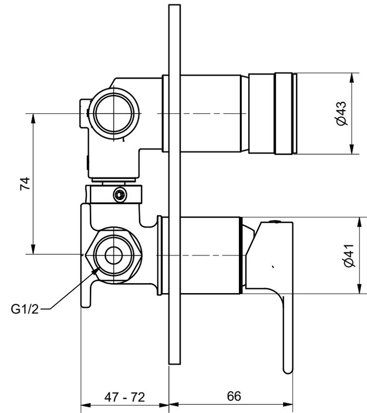
Monocomando incasso con deviatore a 2 uscite manuale SIMPLE
