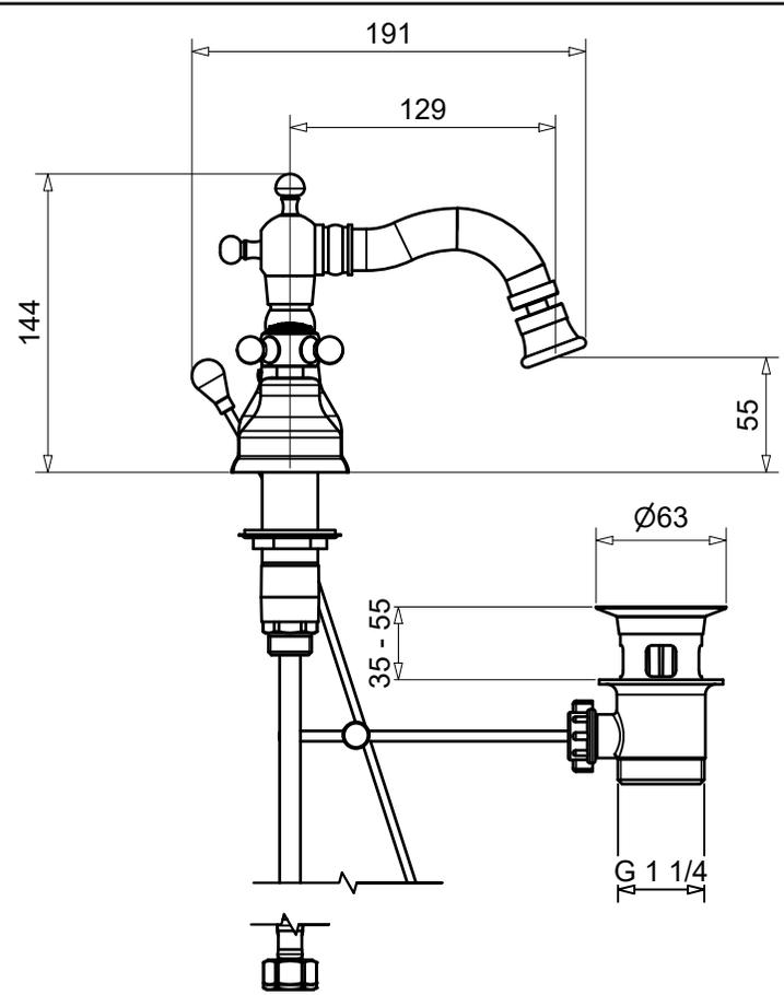
Batteria bidet con bocca erogazione scarico automatico 1"1/4
