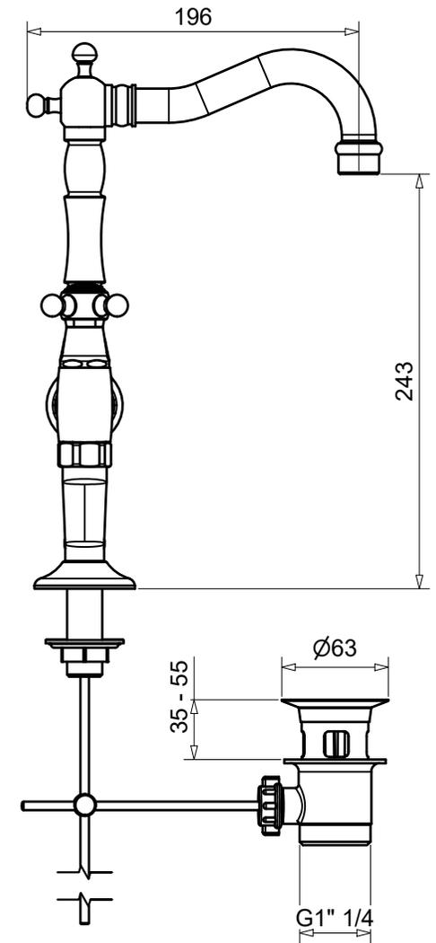
Batteria lavabo a ponte con scarico automatico 1" 1/4 Revival
