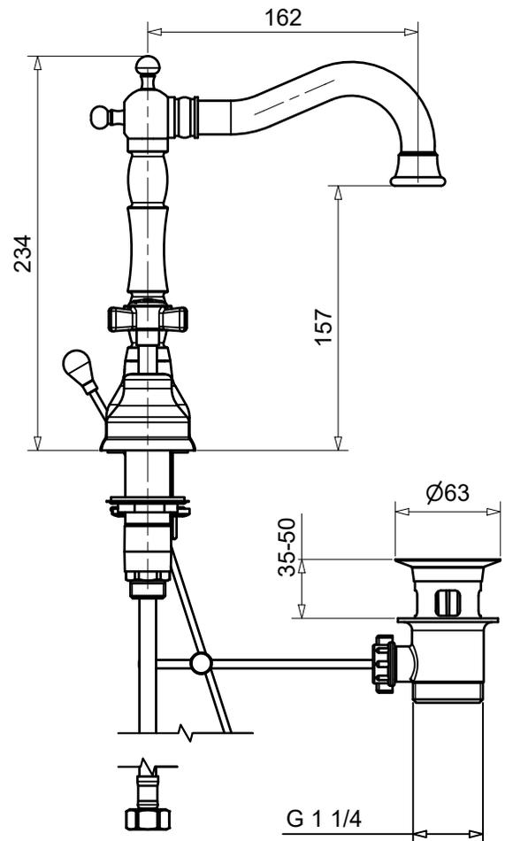
Batteria lavabo scarico automatico 1"1/4 PRINCETON
