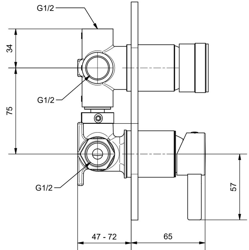
**Monocomando incasso con deviatore a 3 uscite ORION**
