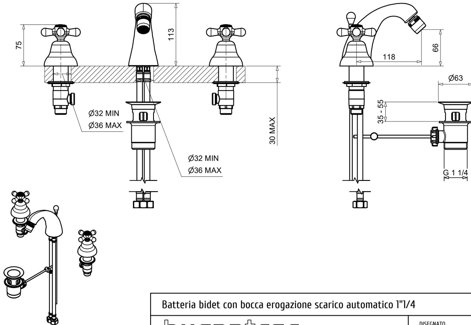
Batteria bidet con bocca erogazione scarico automatico 1"1/4
