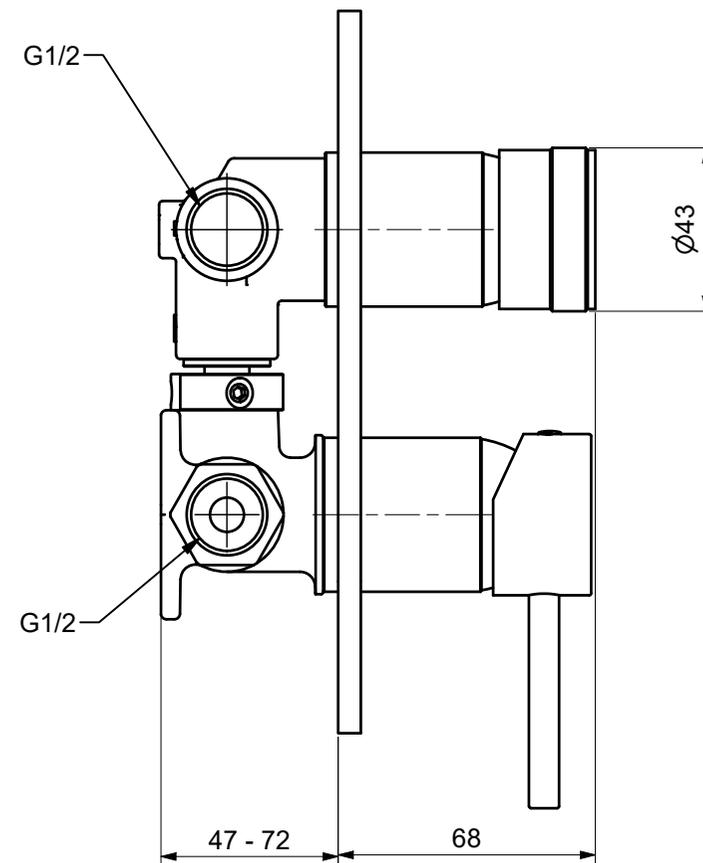
Monocomando incasso con deviatore a 2 uscite manuale K LINE
