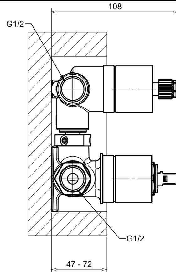
Incasso per monocomando con deviatore manuale a 2 uscite
